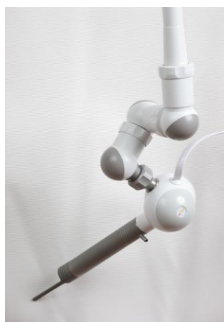
Рис. 9. Оптико-механический сканер СК-К-05.
