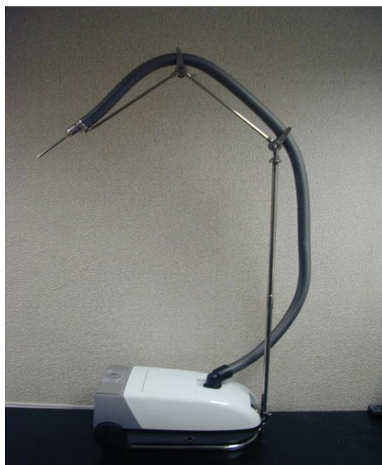
Рис. 8. Система дымоотсоса СД-1.
